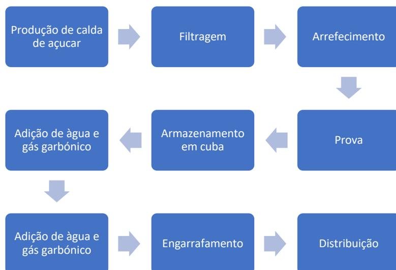
**Figura 9.** Esquema da autora sobre o processo industrial do pirolito.
